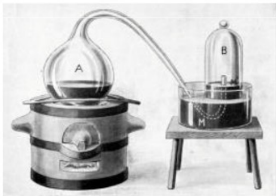
L'expérience de Lavoisier prouvant la composition de l'air, 1774. L'Air en A est chauffé par du mercure, cède une partie (l'oxygène) au métal qui s'oxyde, le reste (l'azote) est récupéré en B.
